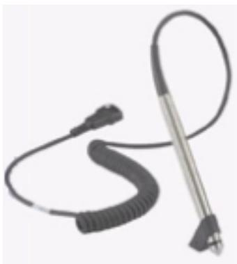
Pour utilisé efficacement le QC650/850 la tête de crayon et son sabot d'inclinaison doivent reposer sur le support de lecture.
