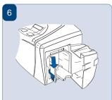
Appuyez sur le levier pour bloquer le plateau d'insertion des cartes.
