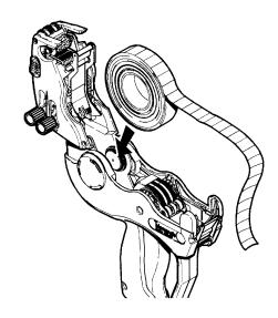
Legen Sie die Etiketten in den Schact ein, und drücken Sie den Auslöser wiederholt, bis die Etiketten ganz in die Etikettiermaschine eingezogen sind. Entfemen Sie lose Etiketten.
